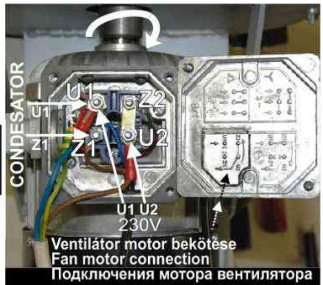
230V egyfázisú motor bekötése
