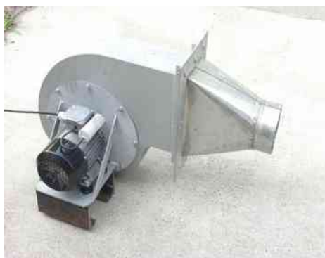
Ventilátor átmeneti idom a füstcső bekötéshez
