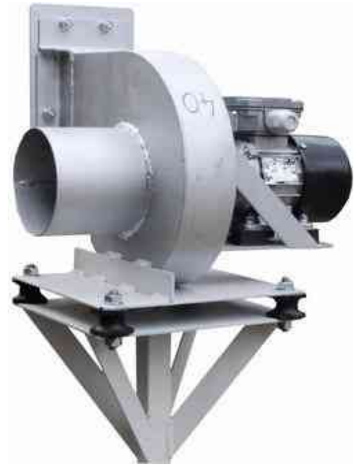
Ventilátor ház felhegesztése a lábás tartó felső lemezéhez
