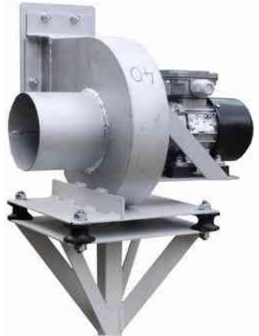
Ventilátor ház felhegesztése a lábas tartó felső lemezéhez
