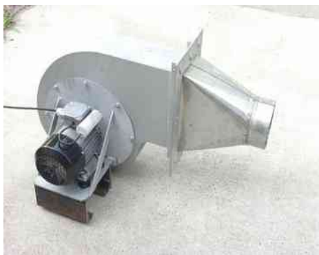
Ventilátor átmeneti idom a füstcső hekkötéshez
