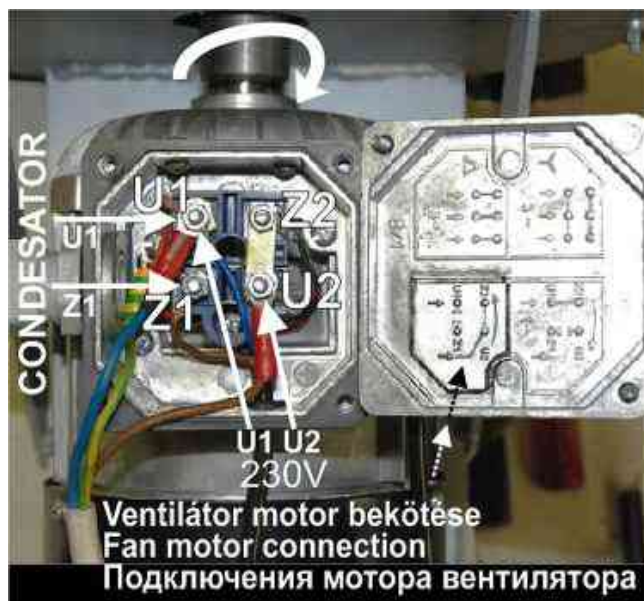
230V egyfázisú motor bekötése
