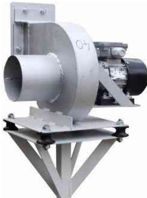
Ventilátor ház felhegyesztése a lábás tartó felső lemezéhez
